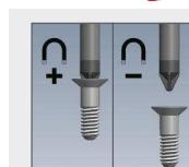
Tornavida, bits uç, allen anahtar vb. aletleri mıknatıslama ve mıknatısını alma amacıyla kullanılır
