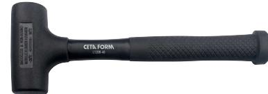
Yağ ve soğuga dayanıklı yüksek kaliteli SBR malzemeden üretilmiştir, kafa iç boşluğunca çelik bilyeler sayesinde geri tepmesiz çalışma imkanı sağlar
